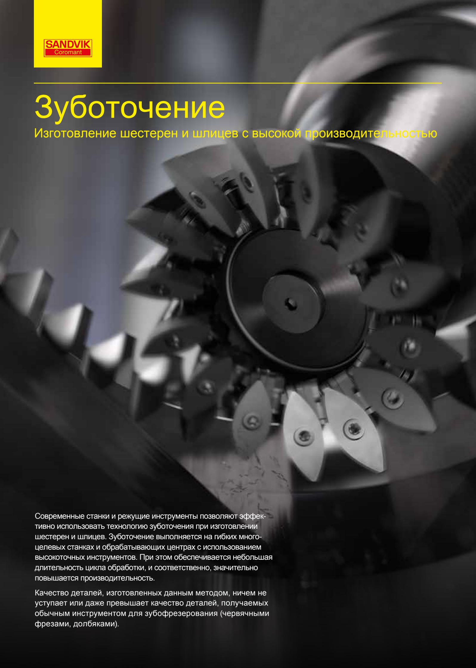
Современные станки и режущие инструменты позволяют эффективно использовать технологию зуботочения при изготовлении шестерен и шлицев. Зуботочение выполняется на гибких многоцелевых станках и обрабатывающих центрах с использованием высокоточных инструментов. При этом обеспечивается небольшая длительность цикла обработки, и соответственно, значительно повышается производительность.
